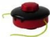
Шпуля для триммера «автомат» 0809.005500 2.4мм отличается от неавтоматической тем, что чтобы заправить леску в шпулю «полуавтомат» нужно открыть корпус шпули и заправить леску на внутреннюю шпулю. Заправка же лески в шпулю «автомат» выполняется без открывания крышки шпули.
